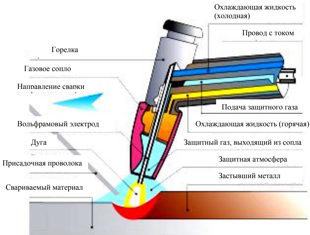
Рисунок Б.1 Схема сварки вольфрамовым электродом в среде инертного газа (TIG)
